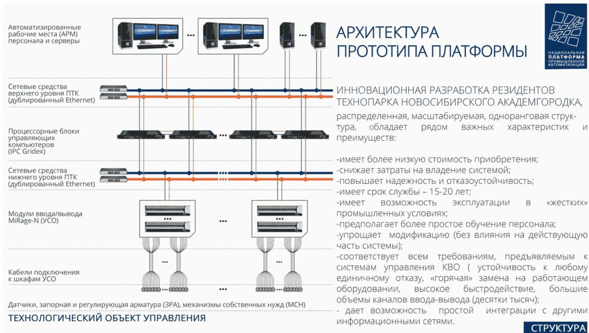
Рисунок 11. Архитектура прототипа НППА
